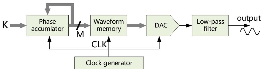
Fig. 1. DDS architecture.
